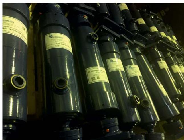
Большинство телескопических цилиндров – одностороннего действия. То есть секции цилиндра выдвигаются с помощью гидравлического давления, но затем складываются с помощью гравитации и массы груза. Типичным примером является телескопический цилиндр в устройстве грузового автомобиля-самосвала.
