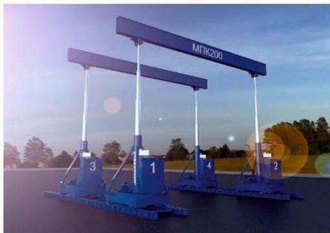
Мобильный порталный комплекс (далее МПК) предназначен для выполнения работ по транспортировке и перемещению нестандартного и крупногабаритного оборудования, в ограниченном пространстве, с высокой степенью точности позиционирования.
